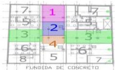
Actualmente el proyecto se encuentra en proceso de fundida de la placa de cimentación, la cual se funde por módulos, determinados por el Ingeniero de suelos. El área general se divide en 8 módulos, de los cuales se encuentran ya fundidos los siguientes: Módulo 1, Módulo 2, Módulo 3 y Módulo 4, los cuales representan un 30% de avance en construcción de cimentación.
