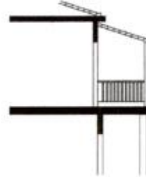
Balcón de la fachada oriental. Una estructura en madera que se apoya sobre muro en mampostería.
